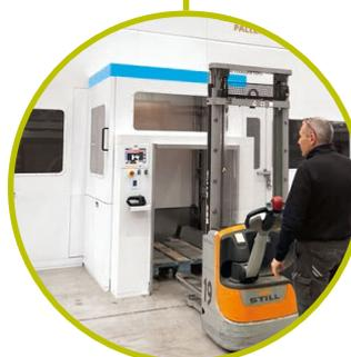
Poste de chargement/de prélèvement flexible, conçu pour être utilisé avec un chariot élévateur manuel ou électrique
