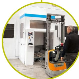
Punto de carga / extracción flexible diseñado para su uso con carretilla elevadora manual o eléctrica
