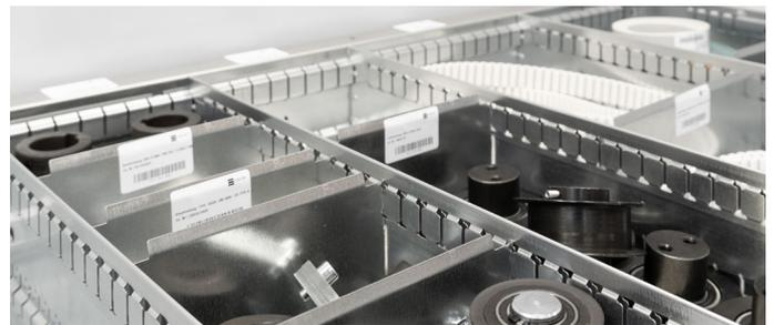
Trennbleche sorgen für optimale Einteilung des Träger- raumes zur effizienten Lagerung unterschiedlich dimensionierter Objekte.
