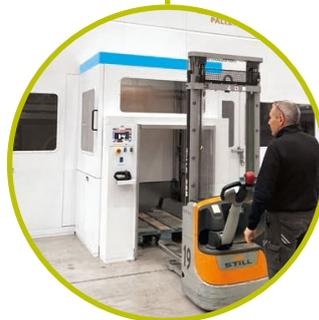
Flexible Lade-/Entnahmestelle, ausgelegt für die Nutzung mit Hand-oder Elektro-Hubwagen
